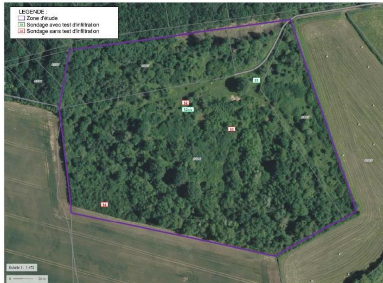
Carte 58 : Localisation des sondages réalisés sur le site (source : Sond&Eau, 2022)
